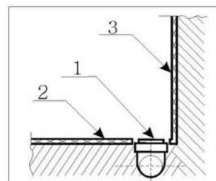
**A** - Вывод канализации устраивается в уровень с полом из стены или из пола под срез кафельной плитки.
