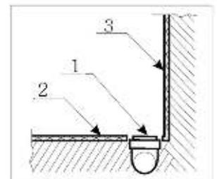
Ⓐ - **Вывод канализации** устраивается в уровень с полом из стены или из пола под срез кафельной плитки.
