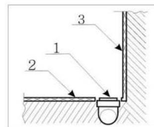
**A** - Вывод канализации устраивается в уровень с полом из стены или из пола под срез кафельной плитки.
