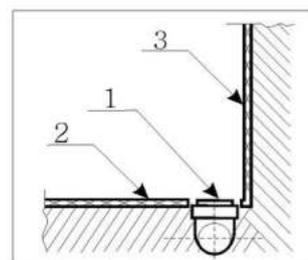
Ⓐ - **Вывод канализации** устраивается в уровень с полом из стены или из пола под срез кафельной плитки.
