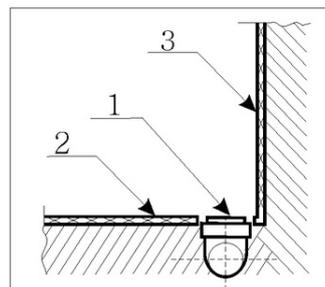
**Ⓐ** – **Вывод канализации** устраивается в уровень с полом из стены или из пола под срез кафельной плитки.
